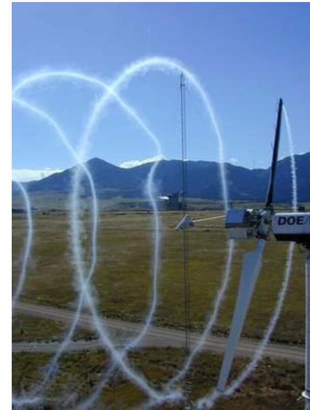
Figure 102 : Effet de sillage derrière une éolienne bi-pale visualisé à l'aide d'un traceur fumée (source : http://www.energieplus-lesite.be )
