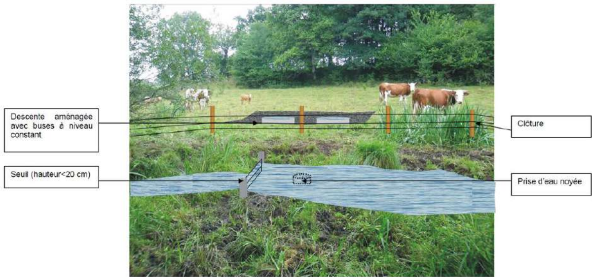
Figure 5 : Photomontage illustrant le principe d'un abreuvoir à niveau constant
