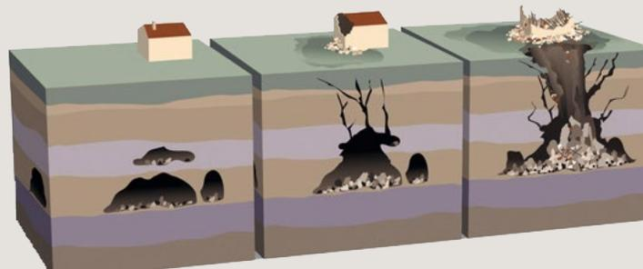
**Les affaissements en surface provoquent des dégâts sur le bâti avec fissurations, compressions, mise en pente...**
