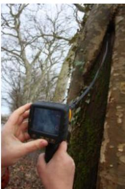
**Visite d'une cavité à l'aide d'un endoscope**
