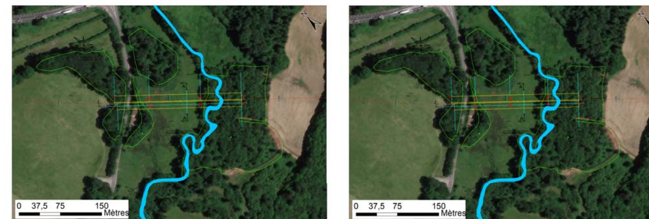
Figure 8 : Emprise du viaduc à 3 travées (Famille A) à gauche, et 4 travées (Famille B, à droite)
