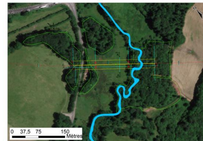
Figure 87 : Positionnement des piles du viaduc
