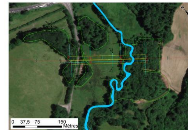
Figure 94 : Emprise du viaduc à 3 travées
