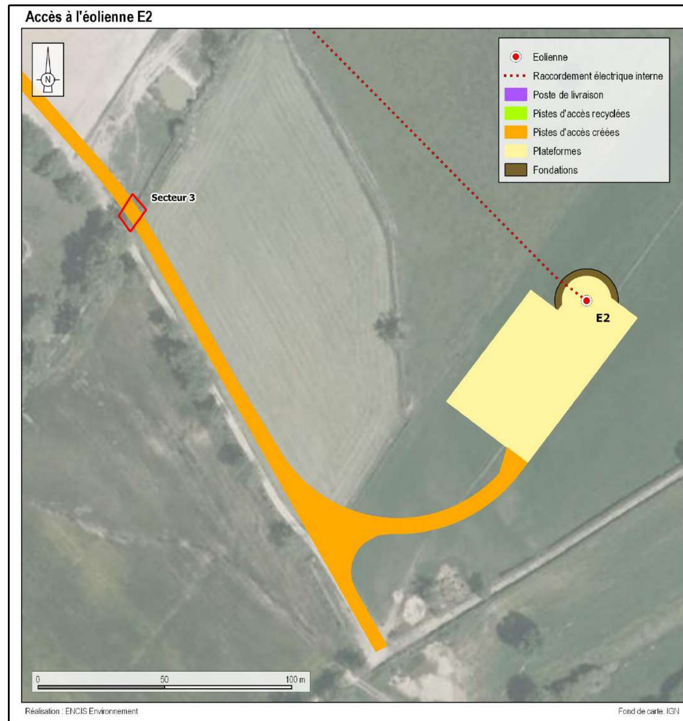
Carte 66 : Secteurs d'abattage de végétation arbustive et arborée pour l'accès à l'éolienne E2
