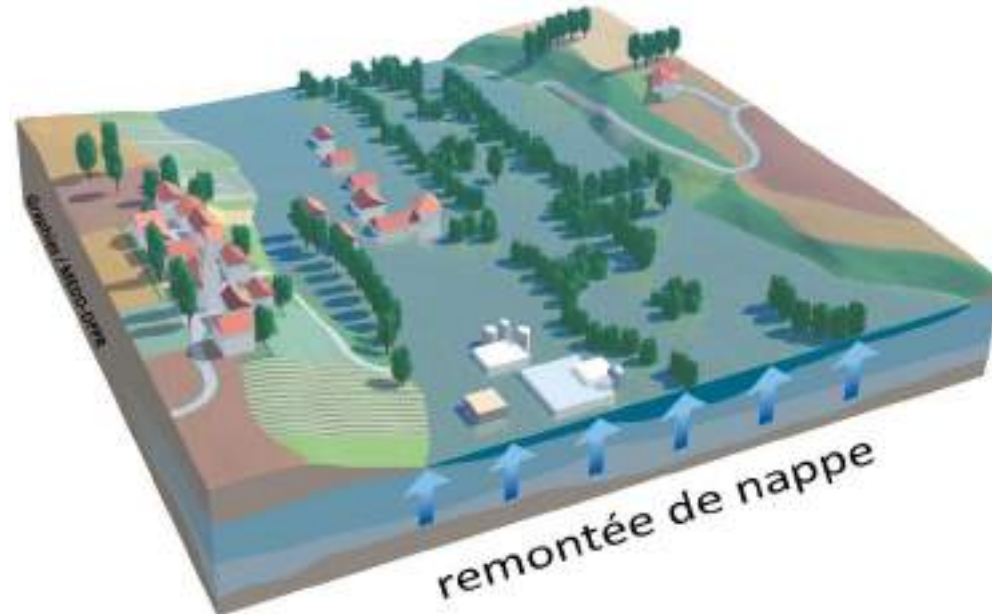
Figure 10 : Le phénomène d'inondation (Source : prim.net)
