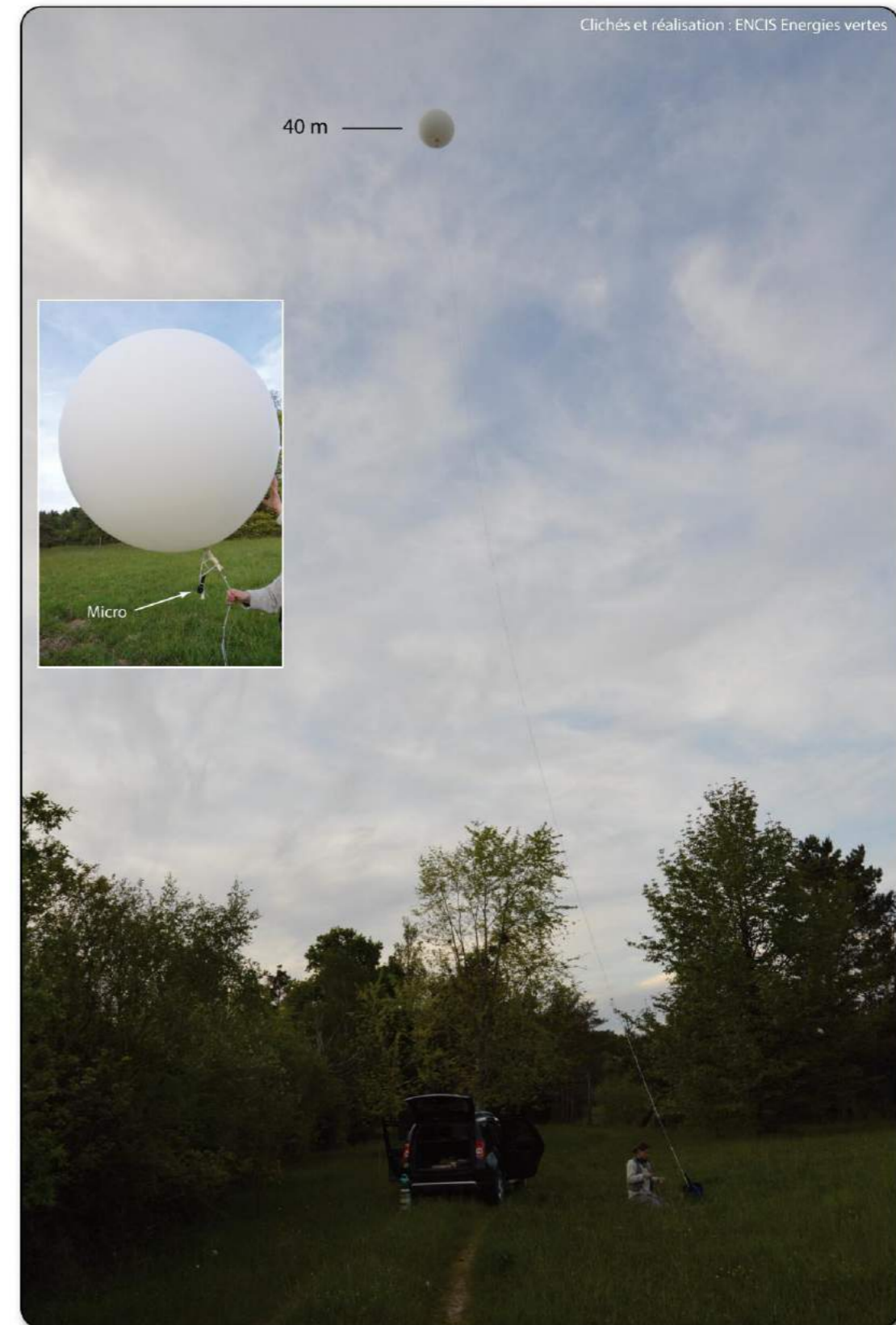
Figure 5 : Exemple de dispositif SM2Bat installé avec le ballon-sonde
