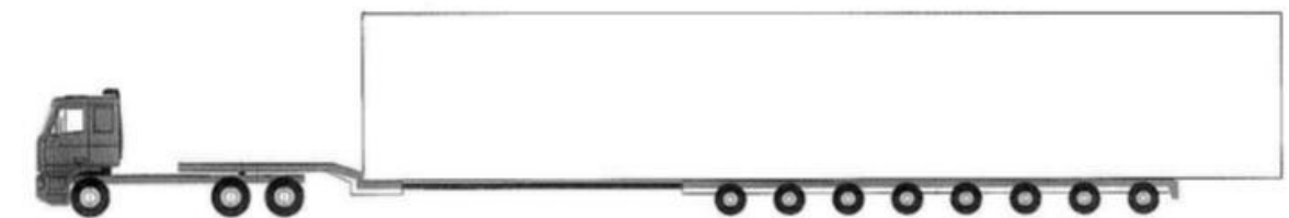
Transport d'une section d'un mât
