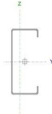
Figure 10 : Section d'un pieu battu
